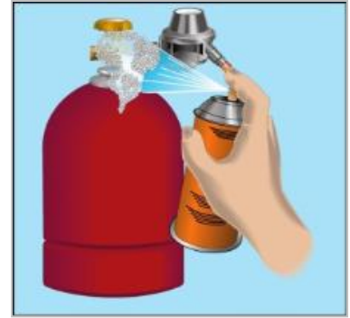
Bild 5 Dichtheitsprüfung der Anschlussverbindung
